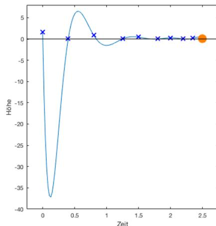
Abbildung 9: Polynominterpolation am Beispiel des springenden Balles mit zehn Keyframes
