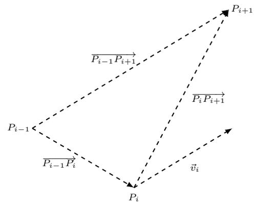
Abbildung 12: Konstruktion des Ableitungsvektors  $\vec{v}_i$
